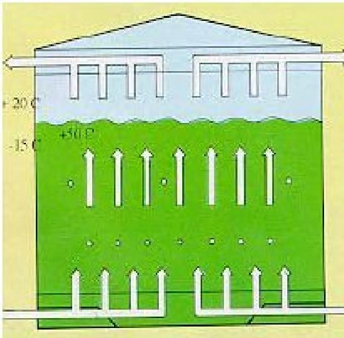
I en komposter sker luftkonditionering med hjälp av skillnaden mellan temperaturen inuti komposten och utetemperaturen,
