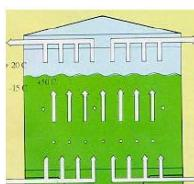
I en komposter sker luftkonditionering med hjälp av skillnaden mellan temperaturen inuti komposten och utetemperaturen,
